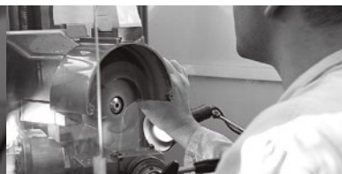
NACINANIE WZORU PRZY UŻYCIU MASZYNY Z DIAMENTOWĄ KONCÓWKĄ.
