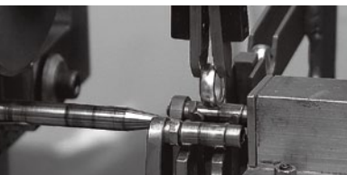
OBRĄCZKA GOTOWA DO NADANIA JEJ ODPOWIEDNIEGO PROFILU PRZEZ WALCOWANIE.
